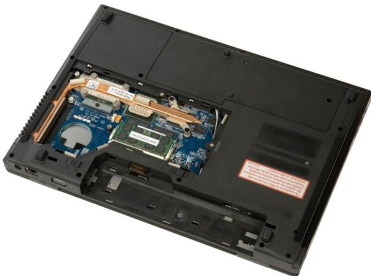
4. Retirez la barrette de mémoire inférieure en écartant du bout des doigts et avec précaution les clips de fixation situés à chaque extrémité de son connecteur jusqu'à dégagement de celle-ci.
