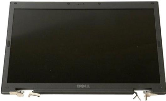
3. Retirez les six protège-vis en caoutchouc du cadre de l'écran.
