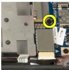
11. Soulevez le module Bluetooth par le bord le plus proche de l'avant de l'ordinateur et retirez le module de son logement.
